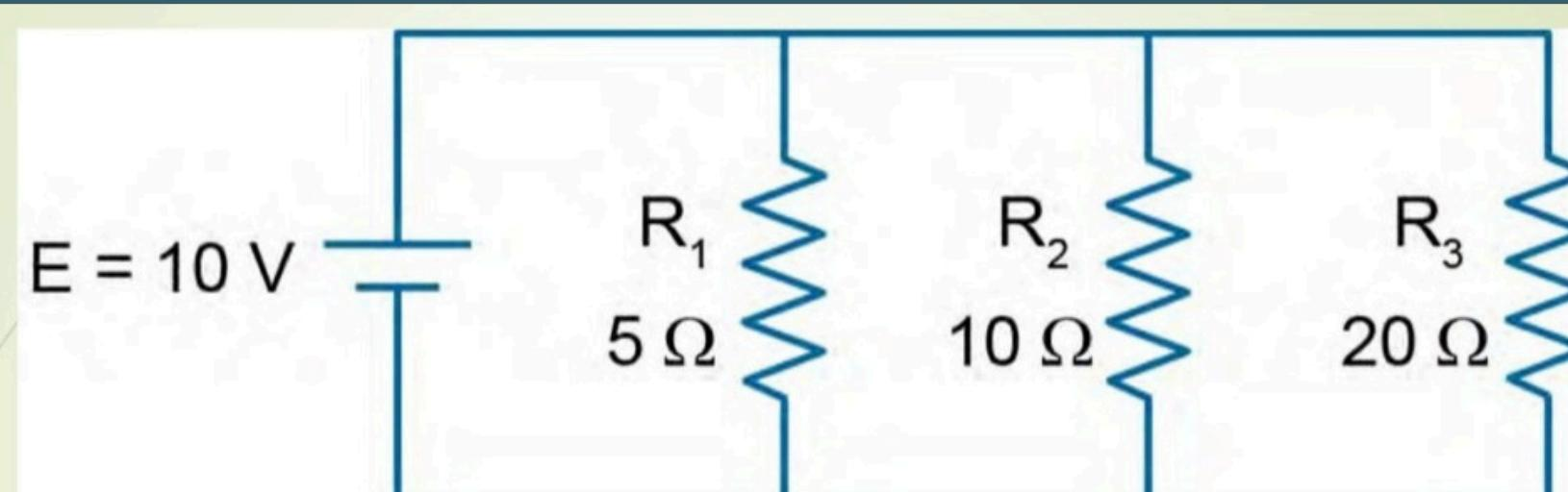
$$I_t = I_1 + I_2 + I_3 = \frac{E}{R_1} + \frac{E}{R_2} + \frac{E}{R_3} = \frac{10\text{ V}}{5\Omega} + \frac{10\text{ V}}{10\Omega} + \frac{10\text{ V}}{20\Omega} = 2\text{ A} + 1\text{ A} + 0.5\text{ A} = 3.5\text{ A}$$
